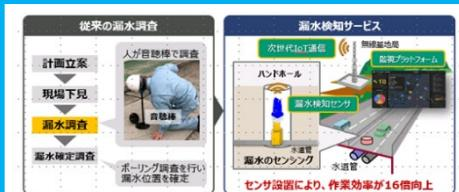
地中埋設インフラの効率的な保守管理に向けデジタルプラットフォームを構築し、漏水の高精度検知を実現。
